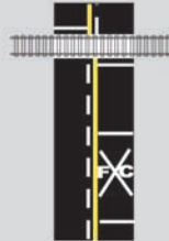
H.13 CRUCE FERROVIARIO
